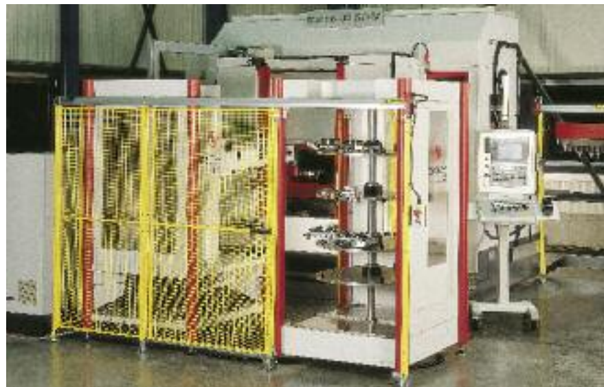
Kundenspezifische Variante für Mehrseitenbearbeitung mit Backgroundmagazin und Palettenspeicher
