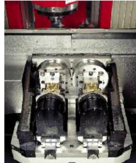
Beladestation mit 2 CNC-Rundtischen und Spannvorrichtung
