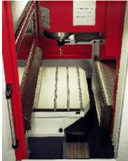
Arbeitsraum mit perfektem Späneabfluss
