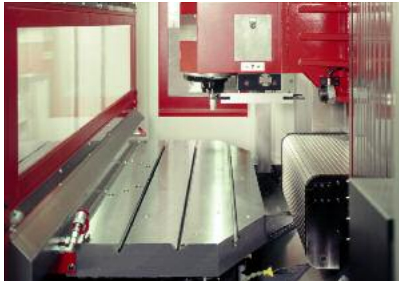
Arbeitsraum mit perfektem Späneabfluss
