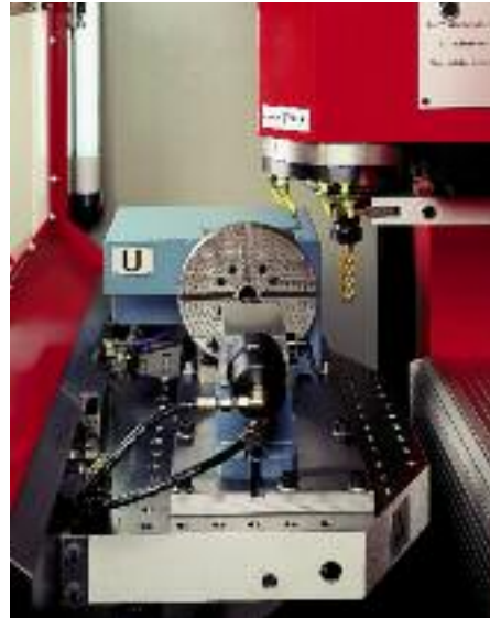
Arbeitsraum mit aufgebautem CNC-Rundtisch und Reitstock
