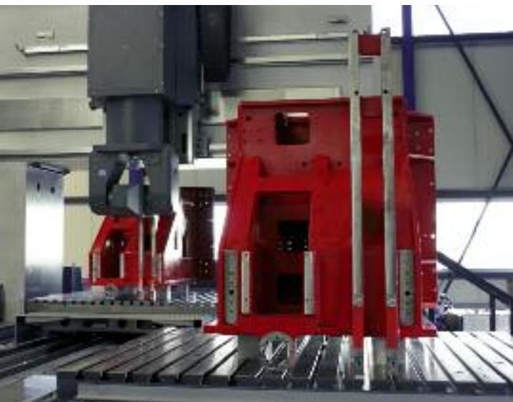
Auf dem neu entwickelten Palettenwechsler können Werkstücke bis 2000 x 2000 mm bearbeitet werden
