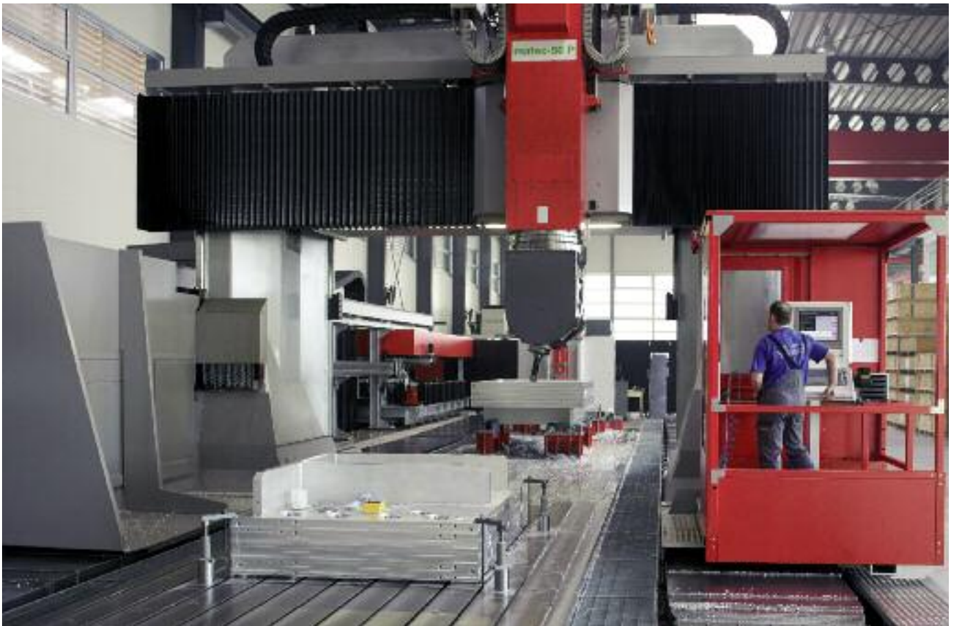
Kundenspezifische Variante matec-50 P mit 2-Achs-CNC-Motorspindelfräskopf,
