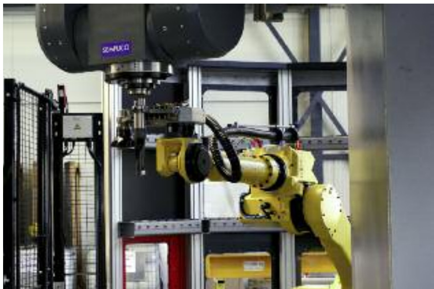
Ein Knickarm-Roboter wechselt die Werkzeuge aus dem neu entwickelten Werkzeugmagazin schnell und sicher ein
