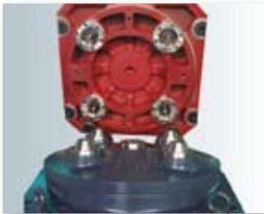
Clamping a pallet using 4 cones in the pallet corners is guaranty for a perfect gripping force of 35,5 kN // Palettenspannung mit Hilfe von 4 Kegeln in den Ecken sichert eine vollkommene Spannkraft von 35,5 kN
