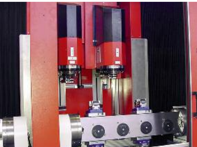
Doppelspindel mit Schwenkbrücke
