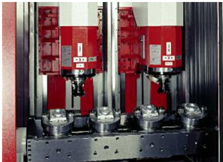
Rechter Arbeitsraum mit Schwenkbrücke und Vorrichtung
