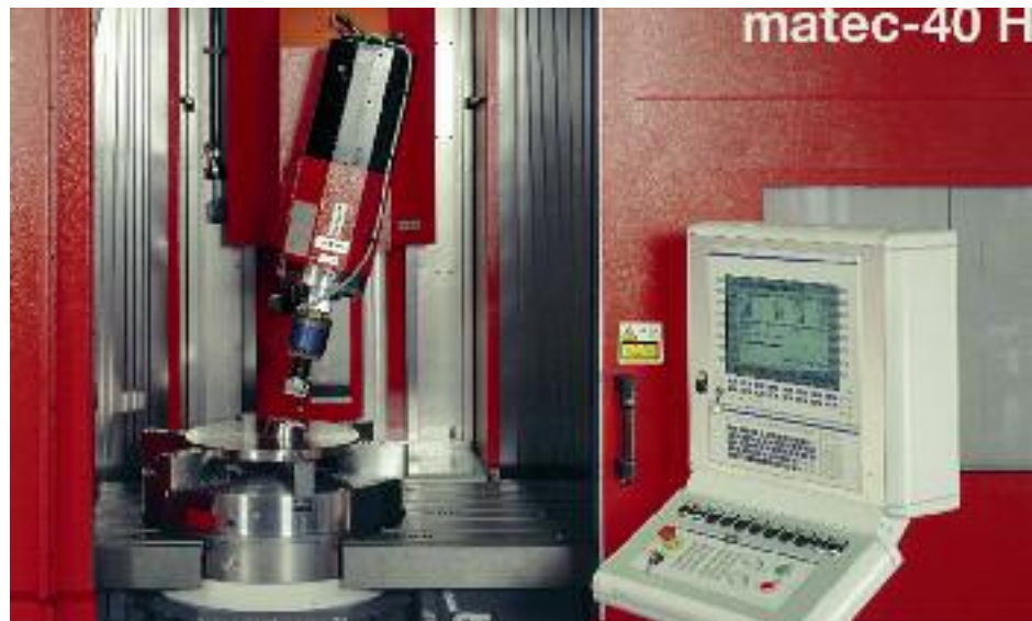
Integrierter Rundtisch mit Torque-Antrieb n_{\max} = 500 \text{ min}^{-1}
