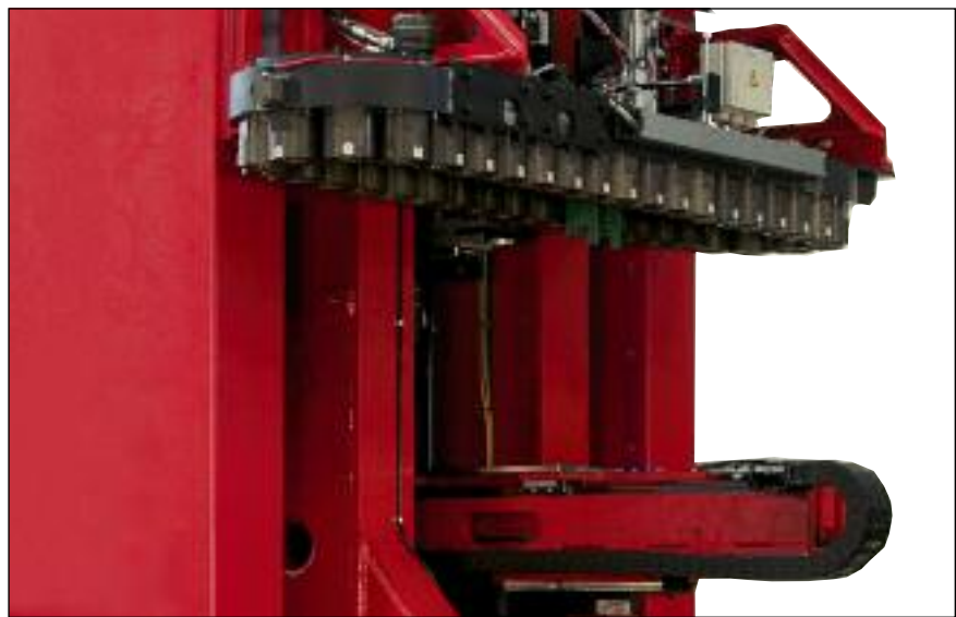
Werkzeugmagazin mitfahrend für 40 Werkzeuge
