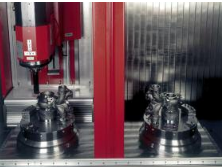
Linker und rechter Arbeitsraum mit aufgebauten Rundtischen
