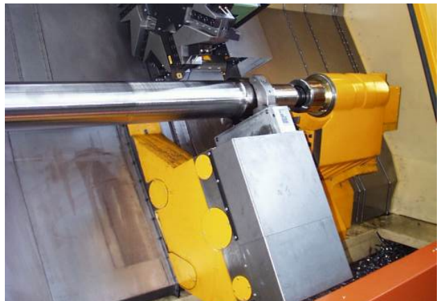
Werkzeugköpfe mit dem Antrieb der Rotationswerkzeuge
