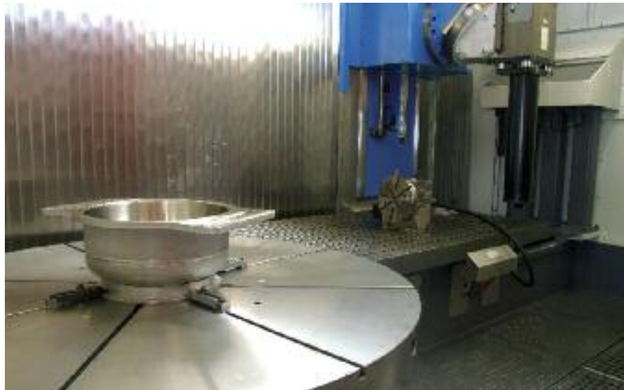
Integrierter Rundtisch und Universalkopf mit Sonderdrehwerkzeug
