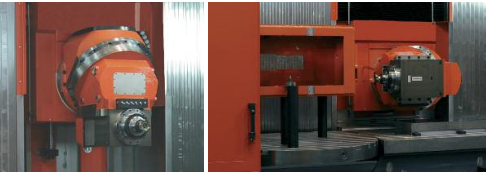
Der Universalkopf ist endlos drehbar
