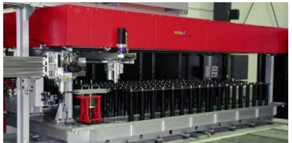
matec-50 P vlak werktuigenmagazijn met 200 posities
