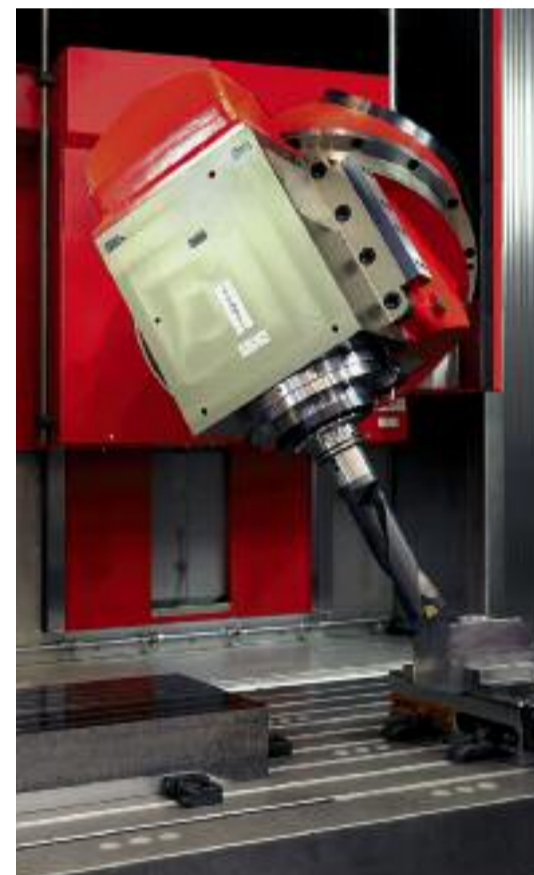
De matec-40 HVU met werktuigopname SK50 resp. HSK-A 100 is ideaal voor zware verspanende werkzaamheden
