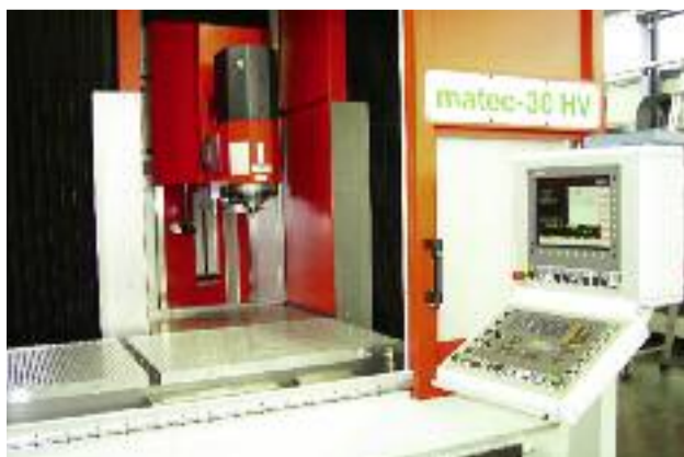
Gedeeld machineplatform met dubbele bewerkingspositie
