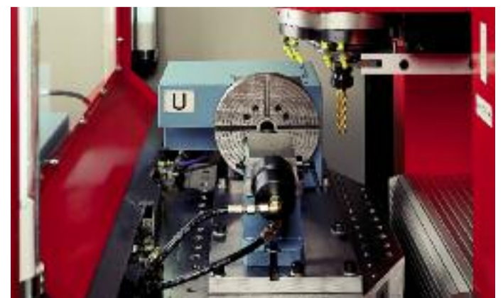
matec-30 S met opgebouwd rond CNC-platform en losse kop
