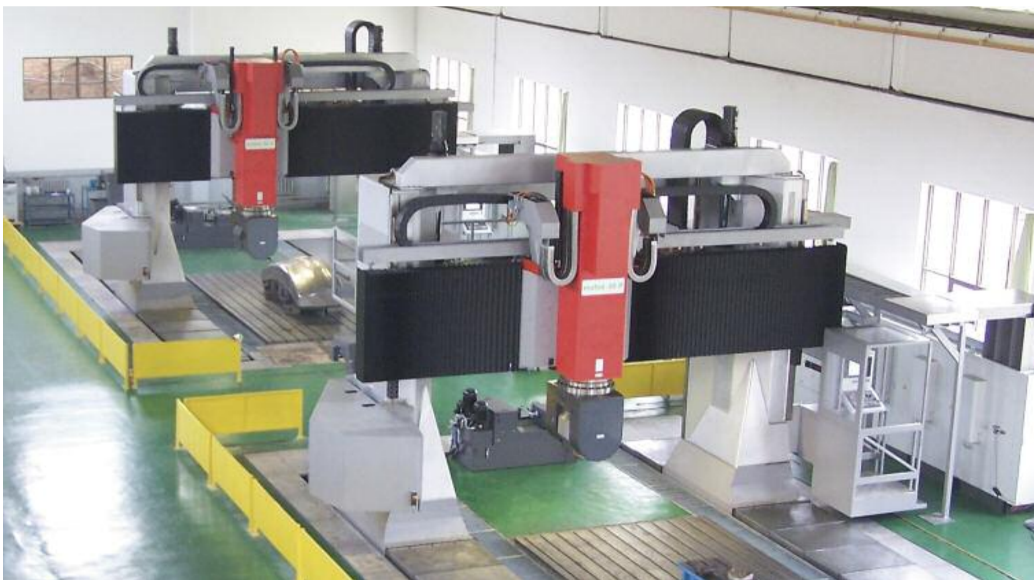
Klantspecifieke variant matec-50 P met 2-assige CNC-motorspilfreeskop en meelopend bedieningsplatform, X = 4000 mm, Y = 5000 mm, Z = 1500 mm, W = 800 mm
