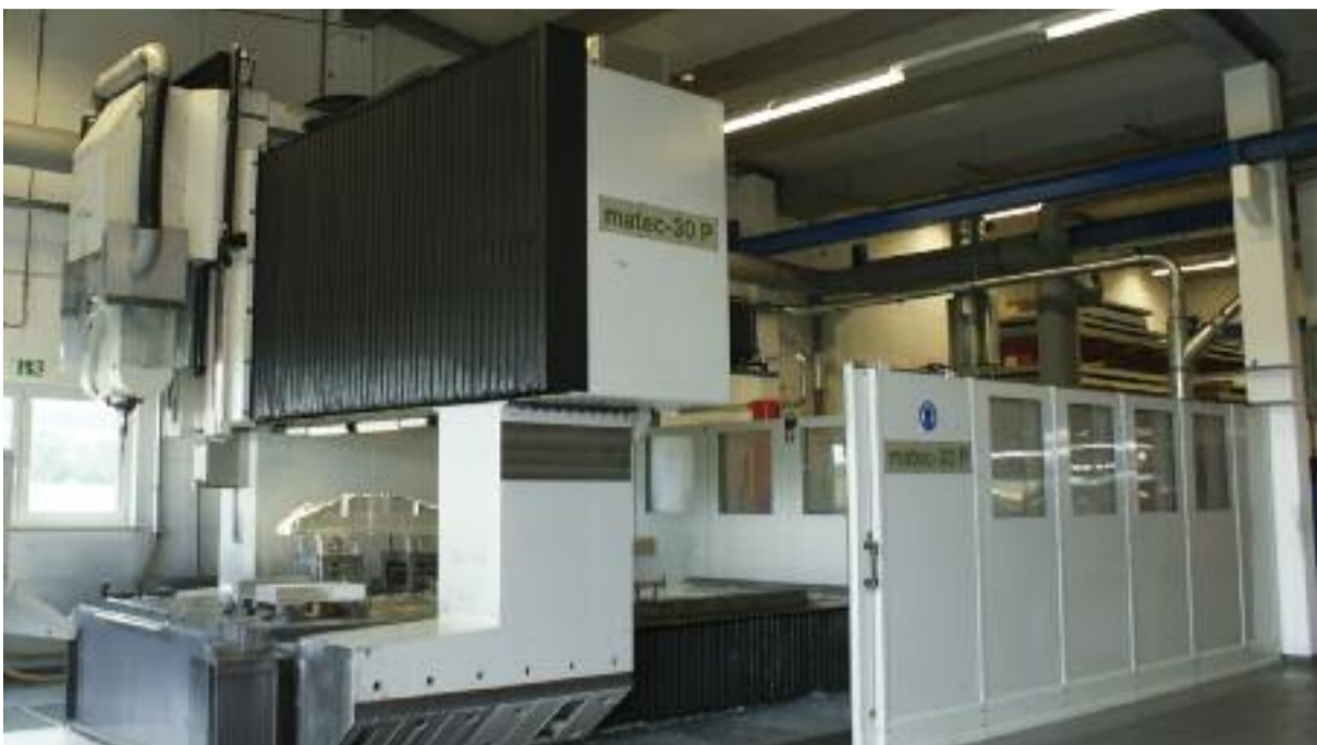
De matec-30P heeft voldoende opspanoppervlakte voor grote en meerdere kleine werkstukken en voor lange onbemande diensten
