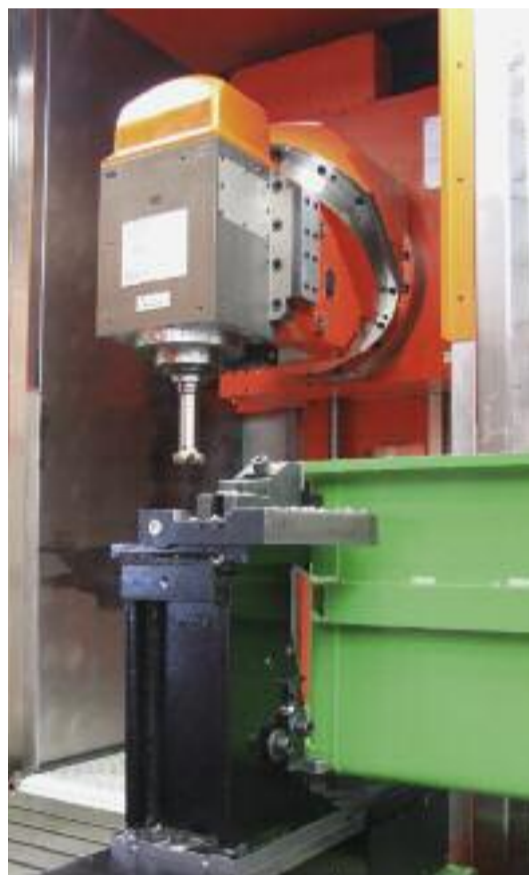
De matec-40 HVU met werktuigopname SK50 resp. HSK-A 100 is ideaal voor zware verspanende werkzaamheden
