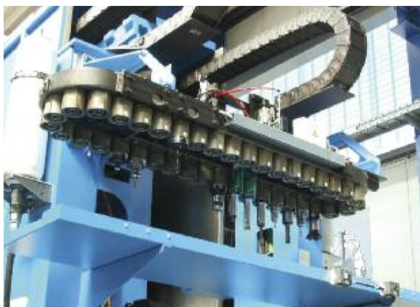
De matec-40 HVU met werktuigopname SK50 resp. HSK-A 100 is ideaal voor zware verspanende werkzaamheden
