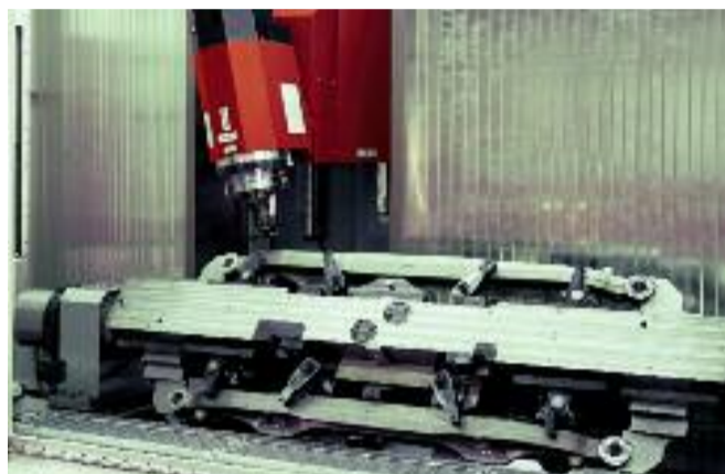
Bewerking van vrachtwagenassen op matec-40 HV
