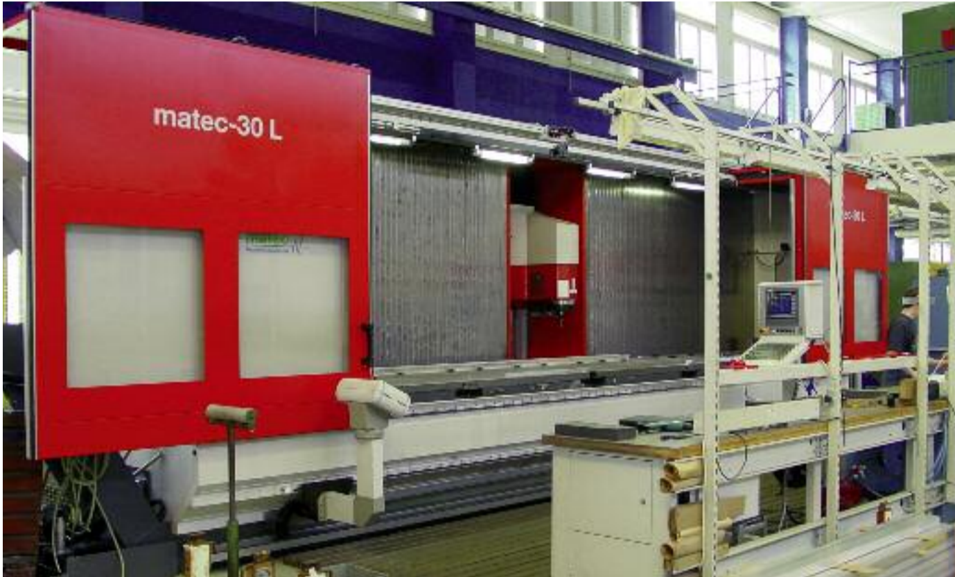
CNC-freeskolom-bewerkingscentrum matec-30 L met traject bereik X=6000 mm, Y=800 mm en Z=800 mm voor de flexibele complete bewerking van werkstukken van alle formaten
