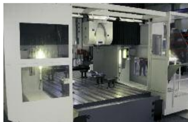
matec-40 P. Verplaatsingen: 6000 x 4000 x 1500 mm.
