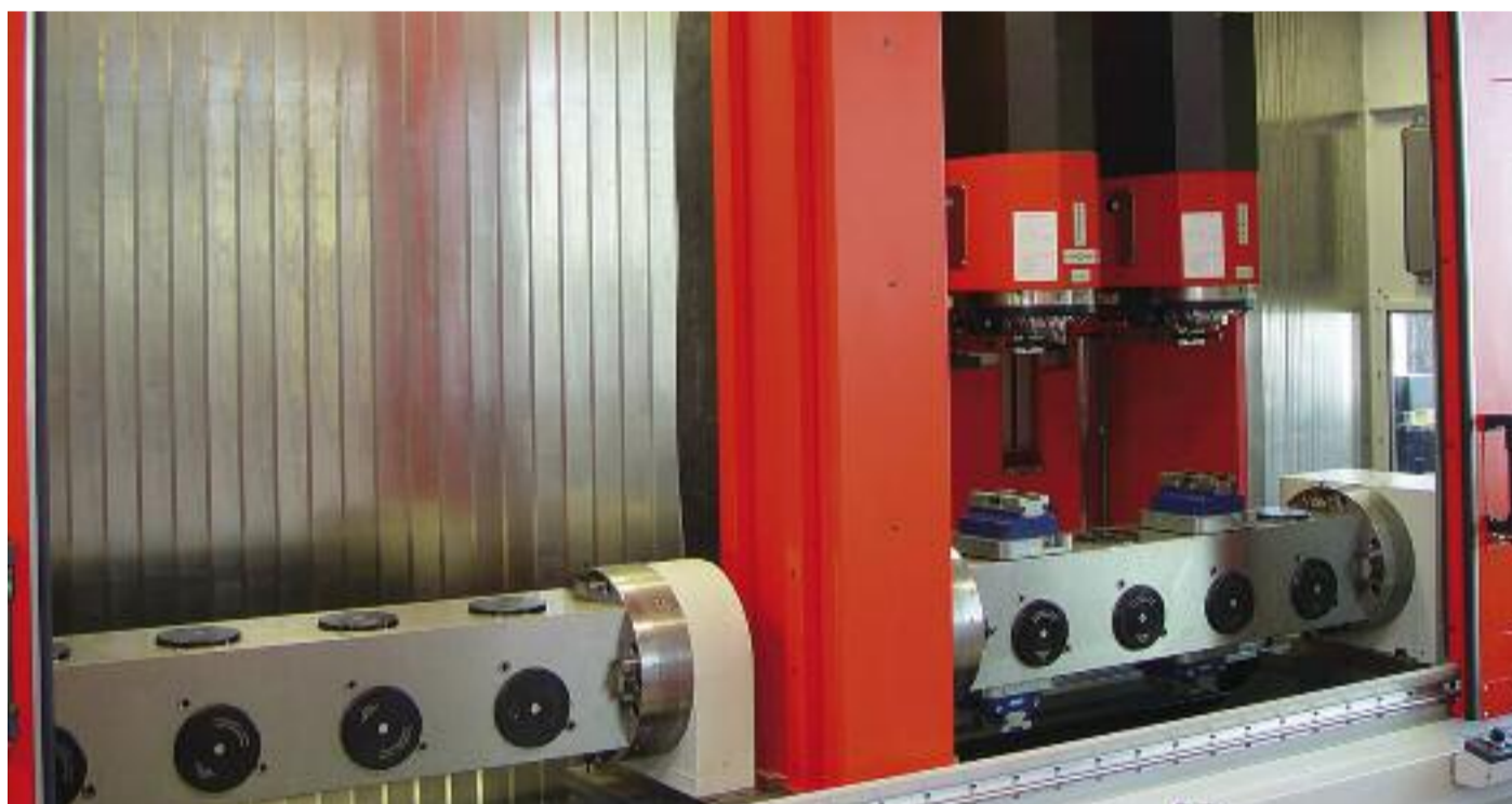
Bewerking van vrachtwagenassen op matec-40 HV
