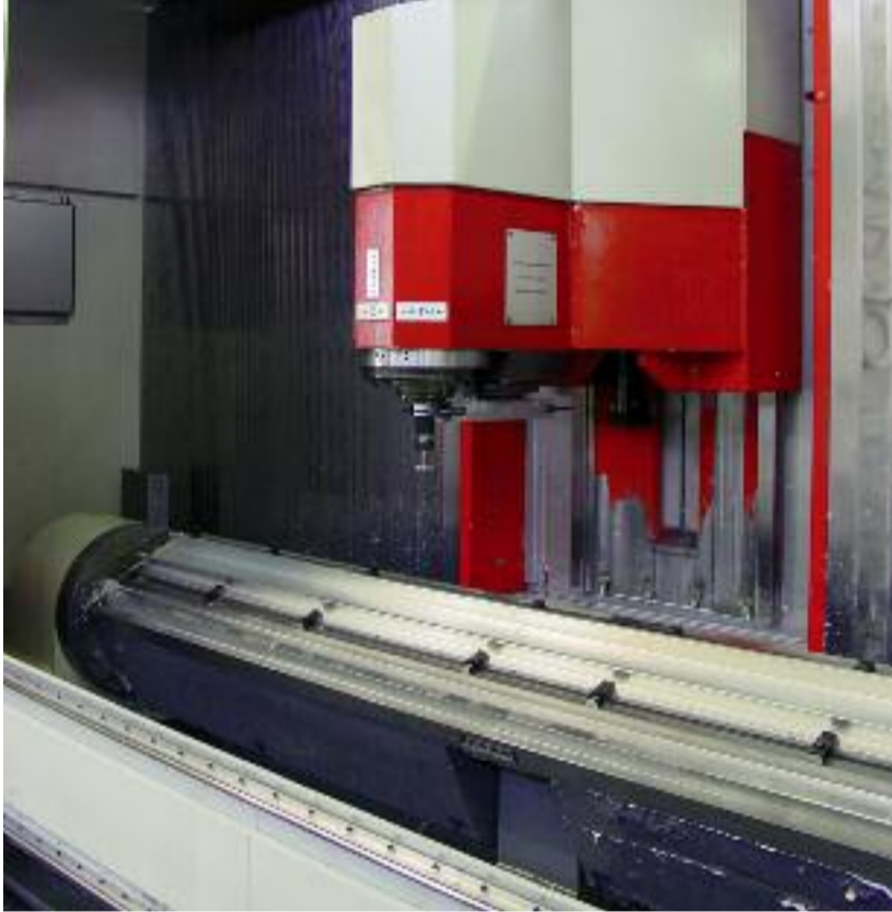
Links: arbeidsruimte matec-30 L, met freeskolom-freeseenheid bij de bewerking van profielen
